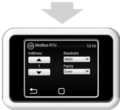
Menu MODBUS RTU slouží k nastavení komunikace Modbus.
