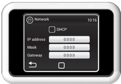
Menu NETWORK slouží k nastavení síťové komunikace jednotky (ModBus TCP)
